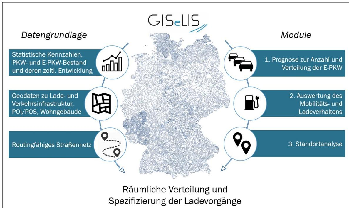
Abbildung 19: Funktionsweise des Standortmodelles für LIS *GiSeLIS*
