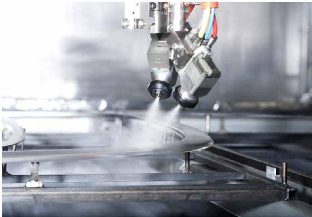
Einsatz des ALUCERAM-Verfahrens zum Schutz der Aluminiumoberfläche
