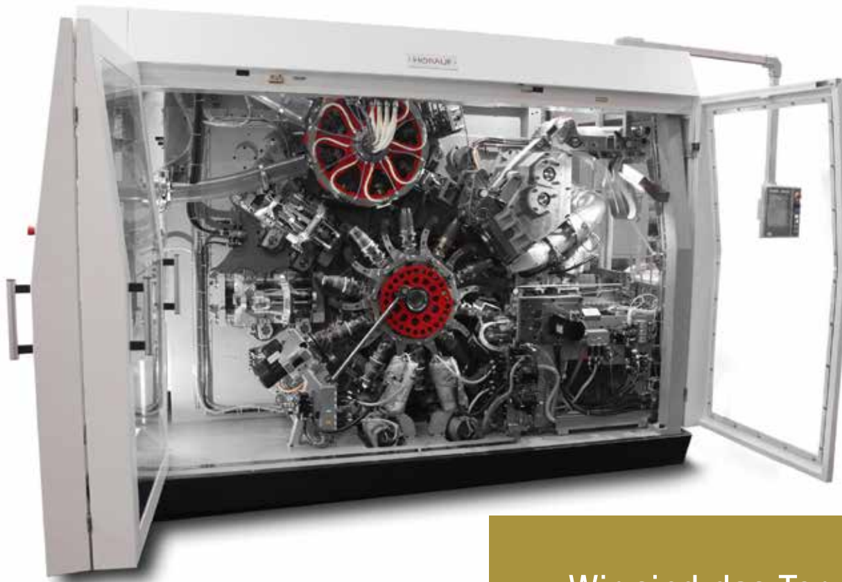
Hightech von HÖRAUF – die BMP 300 zur Fertigung von Papierbechern und Verpackungen aus Papierverbund
