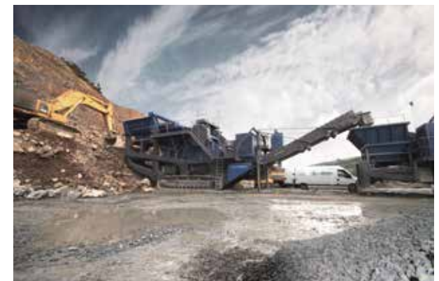
Bei der Aufbereitung von Naturstein im Steinbruch werden größere Kleemann Anlagen wie der mobile Backenbrecher eingesetzt.
