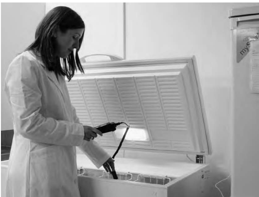
Überprüfung der Temperatur einer Tiefkühleinrichtung
